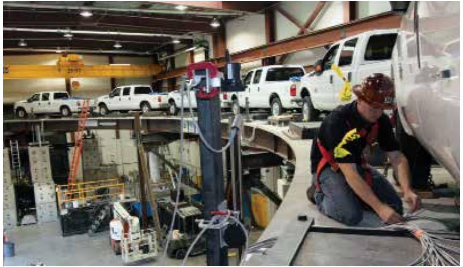
ネバダ大学リノ校 NEES 機器施設で革新的な土木技師が3 スパン橋の 2/5 スケールのモデルを使用し、マルチスパン曲線橋への地震効果を調査
