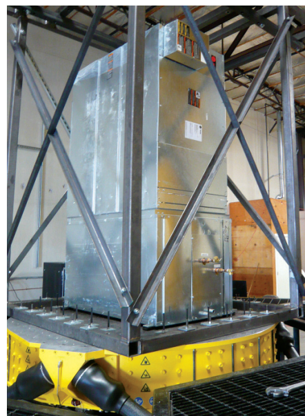
MTS 353.20 MAST™システムは実証された装置で、DCLのOSHPD認証試験機能の迅速な立ち上げに貢献
