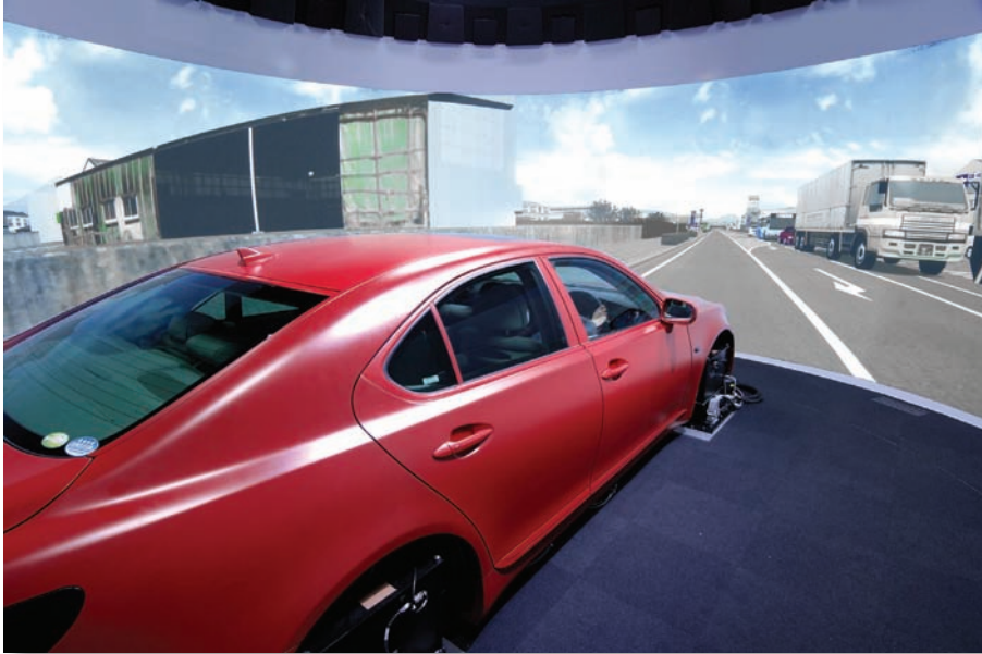
最先端の映像、音声および加速度のシミュレーション技術により、トヨタのドライビングシミュレーターは限りなく実走行に近い試験環境を実現しました
