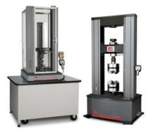
MTS Criterion<sup>®</sup> & MTS Exceed<sup>®</sup> Electromechanical Universal Test Systems
