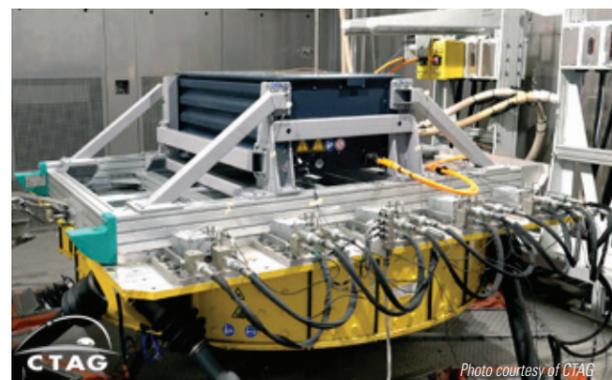
多軸シミュレーションテーブル (MAST) システム
