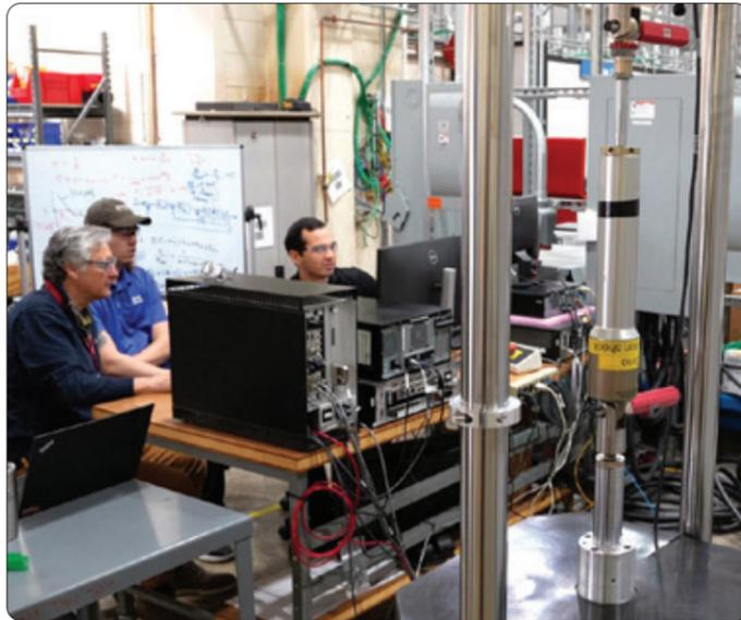
EMA (Electro-Magnetic Actuation, 電磁アクチュエーション) 製品は、ダンパーの性能特性評価に使用される電動式試験システムです。応答性に優れたリニア電動アクチュエータを搭載し、ダンパーメーカーやOEMが求める精度とデータ品質を実現します。近年のバリューエンジニアリングの取り組みから生まれたEMA Gen 2システムは、実証済みのEMA性能と使いやすさを提供するとともに、お客様主導の数々の機械的およびソフトウェア的なイノベーションを活用することで、試験の整合性、システムの有用性、運用効率、安全性の向上を実現します。
