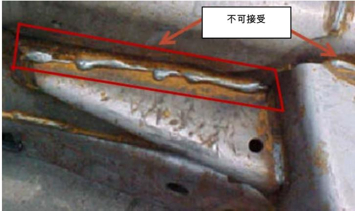
不可接受留有熔渣、氧化皮和腐蚀物。
