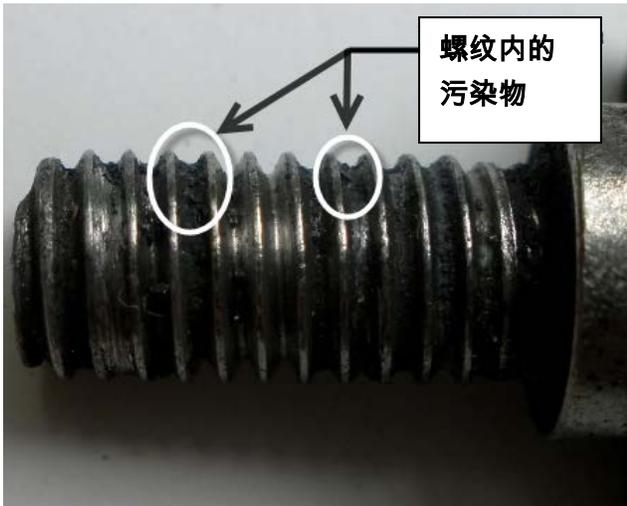
螺□内不得有泥土、□滑脂、碎片和□染物，否□将□致□装不良，液□系□被□染或造成□□的扭力□。
