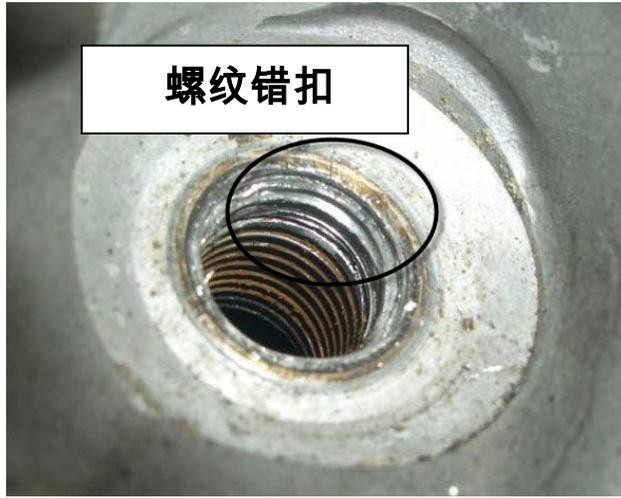
错扣的螺纹不可接受。其可能影响螺纹啮合，并降低固定件强度，造成错误的扭力值和导致整体外观质量不可接受。
