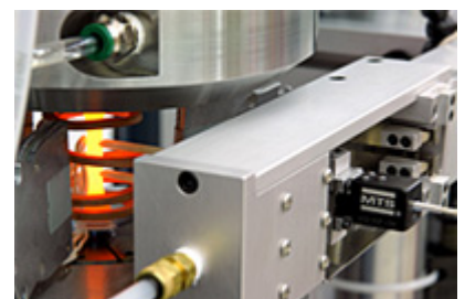
丸棒試験片のTMF試験 誘導加熱装置やアクティブ空冷、高温伸び計
